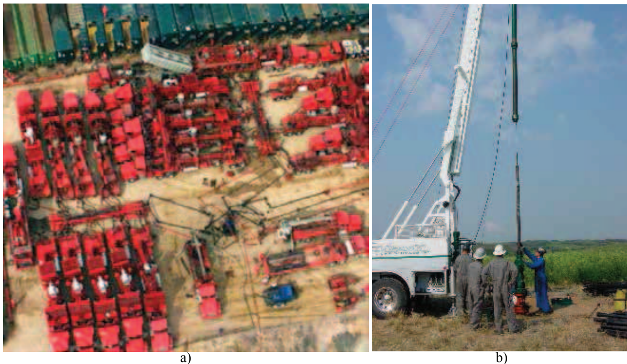
Rys. 17. Porównanie skali przedsięwzięć szczelinowania hydraulicznego i szczelinowania z użyciem paliw stałych: a) Duża operacja szczelinowania hydraulicznego; b) Zabieg z użyciem propelantów
