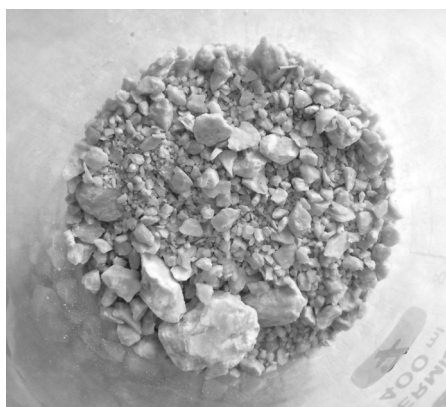
Rys. 11. Typowy granulaty wyflukiwanych cząstek TNT ma postać „grysiu”
