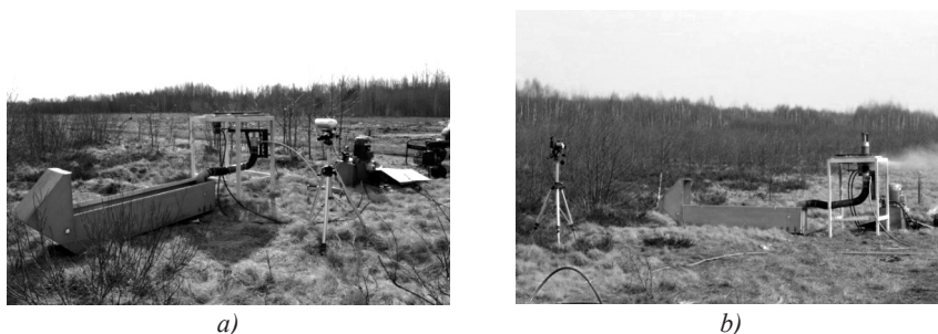
Rys. 2. Widok ogólny uniwersalnego stanowiska badawczego: a) usytuowanie poszczególnych podzespołów; b) proces wyplukiwania TNT z pocisku kalibru 125 mm
