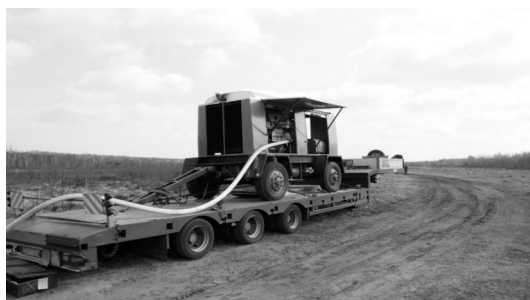
Rys. 3. Wysokociśnieniowy hydromonitor HDP 164 Hammelemann ( p_{\text{maks}} = 300 \text{ MPa} , Q_{\text{maks}} = 0,5 \text{ dm}^3 \text{ s}^{-1} )
