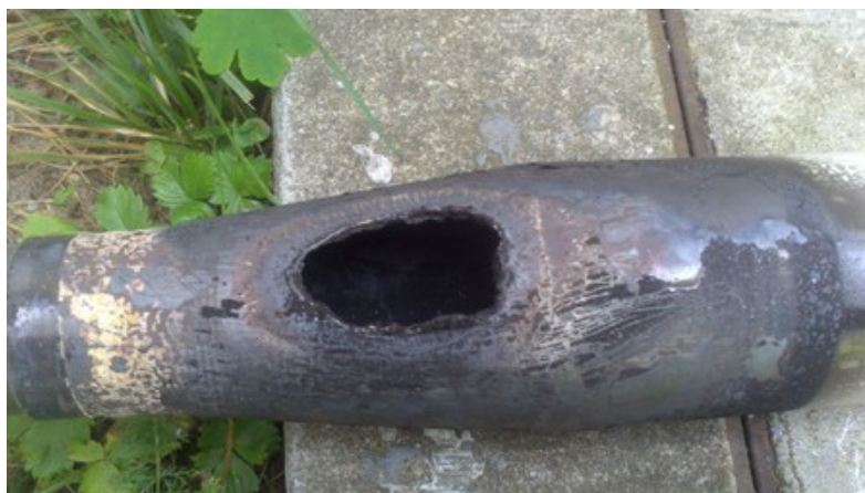
Rys. 1. Efekt przepalenia metalowego korpusu silnika raketowego
