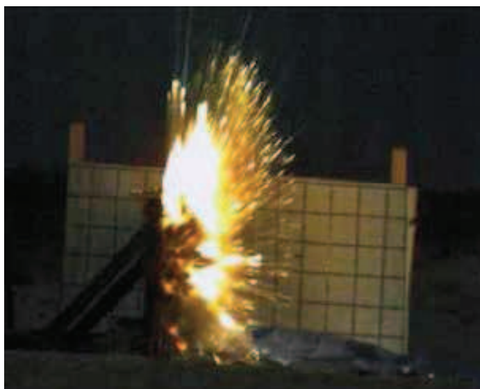
Rys. 4. Moment uderzenia pocisku o płytę pancerną
