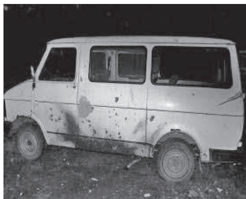
Rys. 1. Przebicie blachy karoserii przez odłamki uformowane w wyniku detonacji dynamitu 20G5H umieszczonego w 2-calowej mufie stalowej
